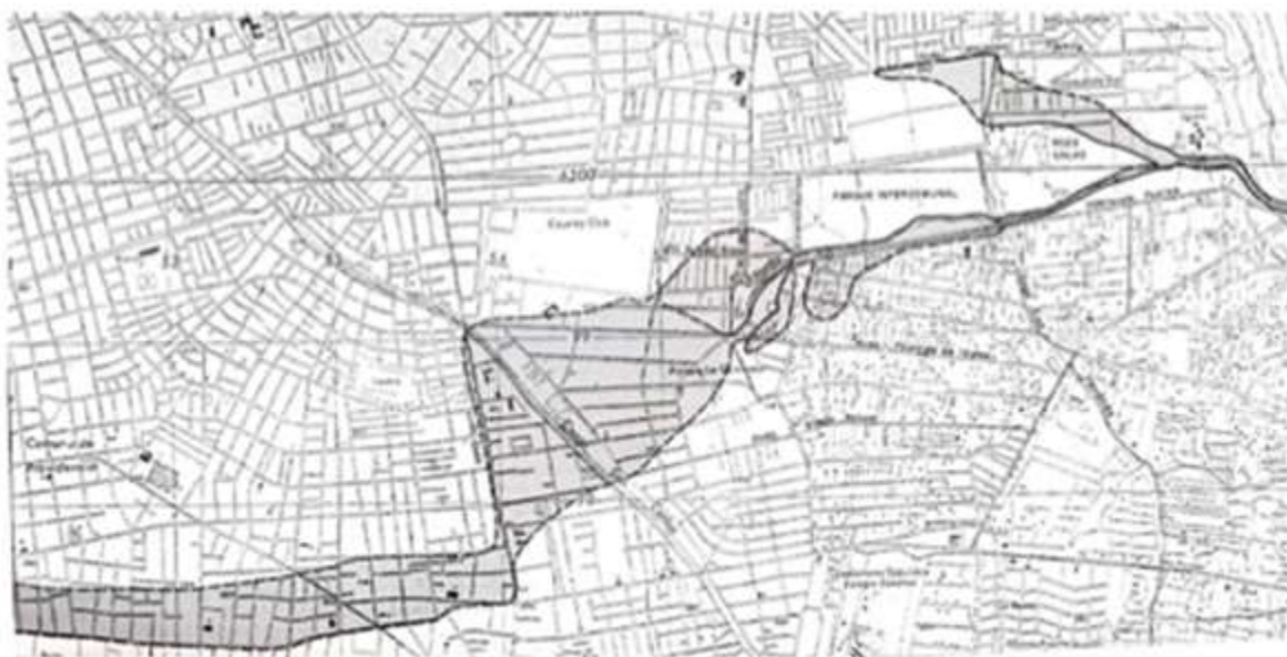
Figura 3: Alcance de los flujos de detritos ocurridos en el evento de 1993 en la Quebrada de Ramón. (Fuente: Naranjo y Varela, 1996 en Lara, 2007).
