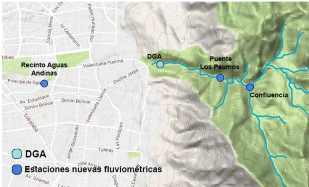
Figura 5: Mapa de las estaciones fluviométricas instaladas y la estación DGA. (Fuente: Elaboración propia)
