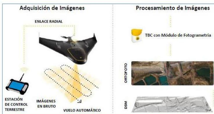
Figura 2-1 : Esquema funcionamiento UX5
