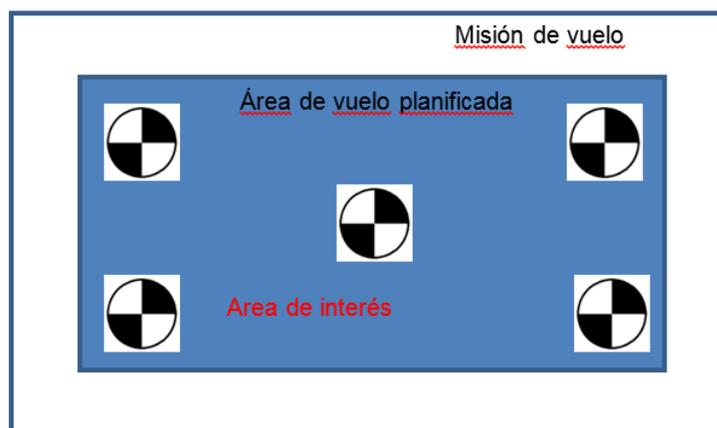
**Figura 4-6 : Distribución puntos de control terrestre**
