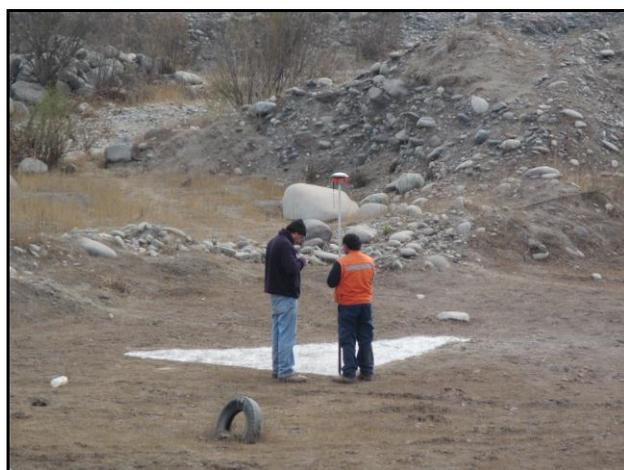
**Figura 4-7 : Medición de punto de control terrestre con GPS RTK**
