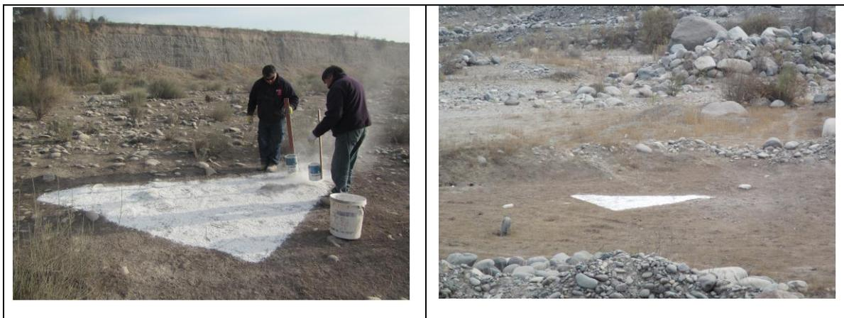
**Figura 4-5 : Materialización de puntos de control terrestre**
