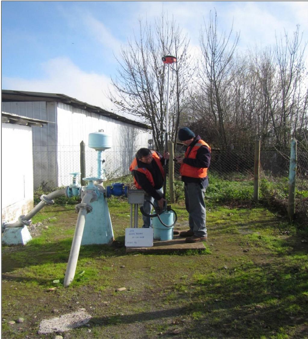
Georreferenciación de pozos utilizando metodología GPS RTK.
